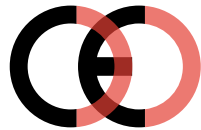
Falsche CE-Kennzeichnung (zu dicht)
